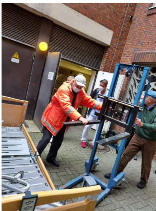
Verladung von Betten mittels einer handbetrieben Hebebühne auf dem Hof des Friederikenstifts in Hannover
